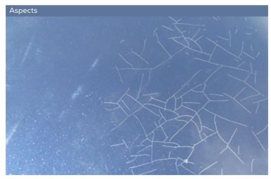
Pequeñas fisuras en la superficie de la pintura que alcanzan a una gran extensión.
